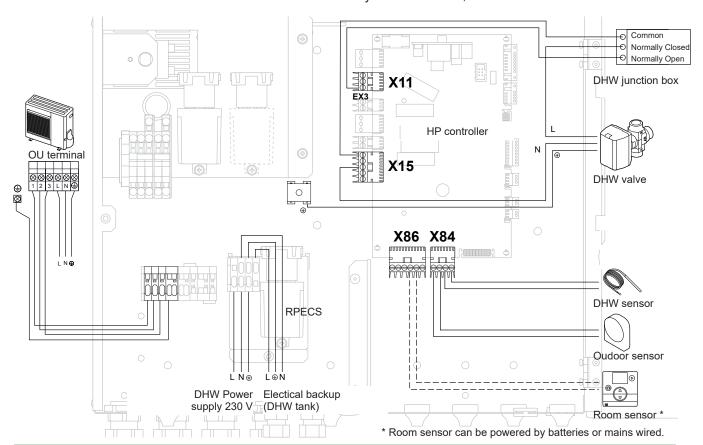
fig. 45 - DHW electrical connections
